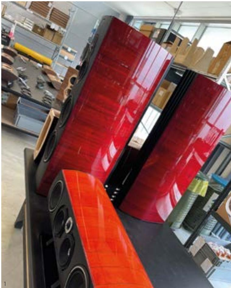
nisteries sont constituées de couches de bois de densités différentes, avec de nombreuses entretoises internes, l'assemblage est consolidé par un axe en acier, les pièces sont assemblées, collées et vissées jusqu'au seuil de rupture pour garantir un ensemble totalement inerte et insensible aux vibrations parasites du coffret.
